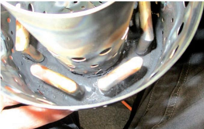
**Die Lager nach dem 35 Stunden-Test.**
