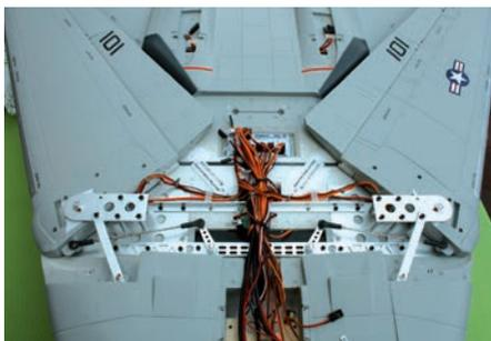
Schwenkantrieb ist komplett in Aluminium aufgebaut mit kugelgelagerten Schwenklagern und elektrischem
