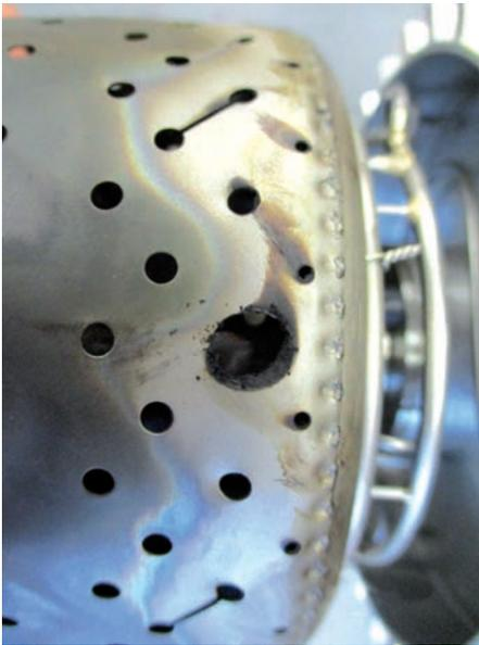
**Die Brennkammer nach dem Test.**
