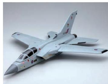
Der *Tornado* von Kyosho mit den Tragflächen in der vorderen Schwenkposition. Die Tragflächen können lediglich am Boden verstellt werden.
