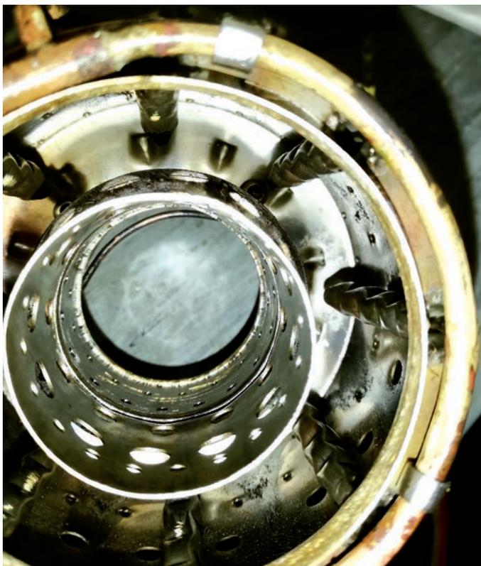
Die Brennkammer nach dem 35 Stunden-Test.
