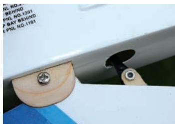
Das Schwenklager und die Ansteuerung der Tragfläche der *Jet Vision*.
